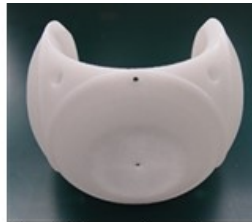
Pièce fabriqué par frittage de poudre
